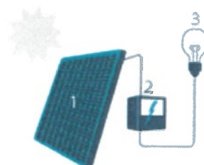
1 zonnepaneel 2 omvormer 3 elektriciteitsinstallatie
