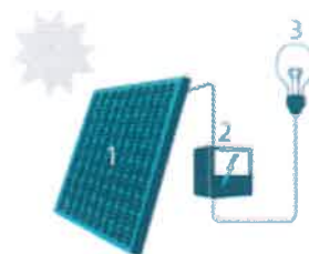
1 Zonnepaneel | 2 Omvormer | 3 Elektrische toestel
